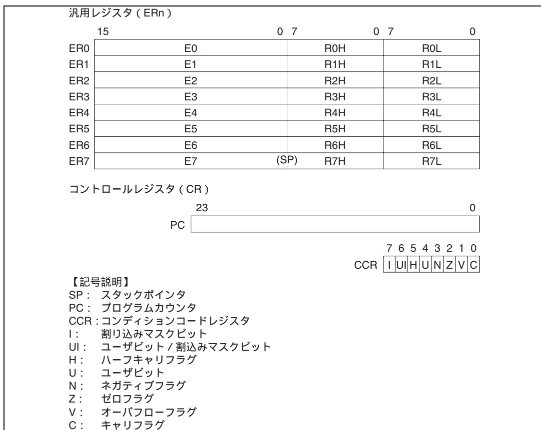
図 2.3 CPU 内部レジスタ構成
