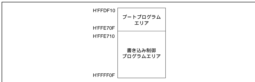
図 18.7 ブートモード時の RAM エリア
